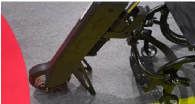
C'est un **nouveau système de propulsion devant le fauteuil roulant** pour les personnes ayant une bonne mobilité du tronc. Les 2 roues parallèles permettent d'avancer en balançant le buste en avant et en arrière pour freiner ou reculer. Un guidon permet de tourner d'une main.
