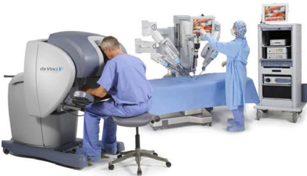
La première est placée au dessus de la personne à opérer. Plusieurs bras manipulateurs peuvent agir dans toutes les dimensions. Un bras comporte une caméra endoscopique et les autres comportent des instruments chirurgicaux dont un bistouri électrique pour découper les tissus.
